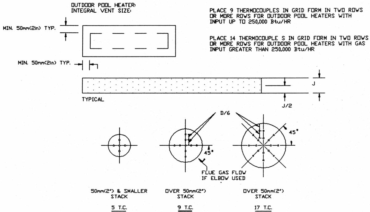
THERMOCOUPLE (T.C.) GRID
